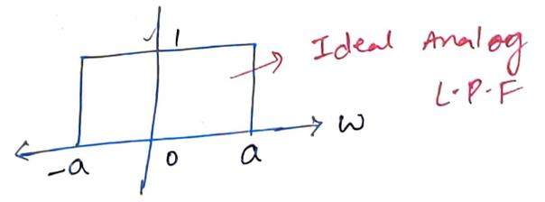
for  $\overset{\text{D.T.F.T}}{\frac{\sin \omega_c n}{\pi n}} \longleftrightarrow \text{F.T}$
